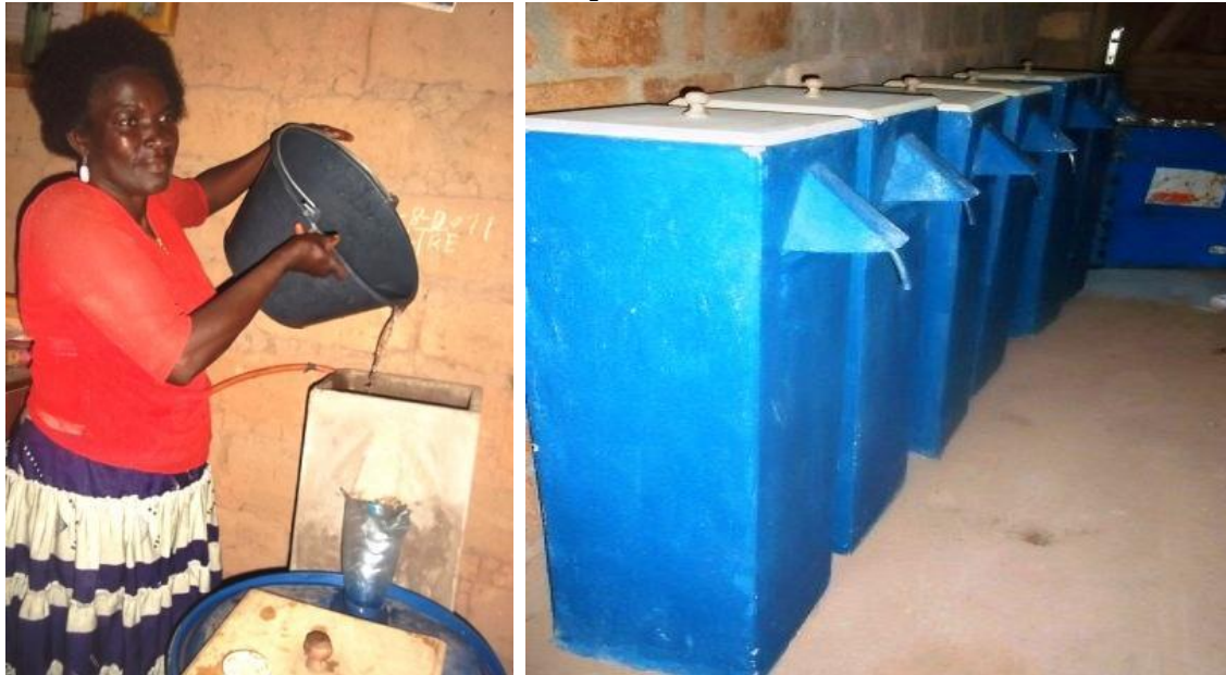
Filtres bio-sables fabriqués à TOCKEM
